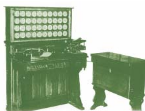
Az első elektromos lyukkártyagép a számlálóművel, a pecsételő-lyukasztóval és az osztályozólával
