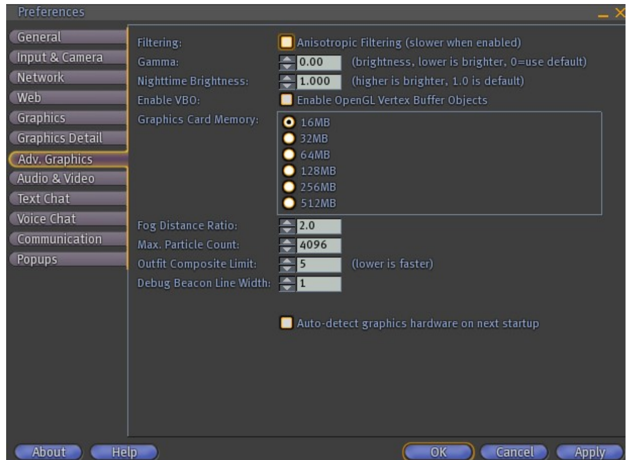
Figure 3.8 Choisissez l'option la plus faible dans Graphic Card Memory et désactivé l'option Enable OpenGL Vertex.
